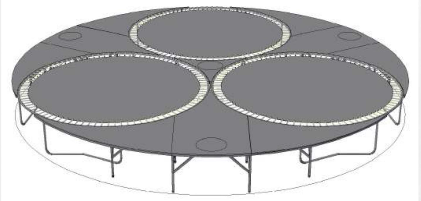
La scène circulaire mesure 90 cm de haut et 9m de diamètre. Elle propose des espaces rebondissant grâce à trois trampolines et des planchers munis de trappes, permettant les apparitions/disparitions et la circulation des artistes sous la scène.
